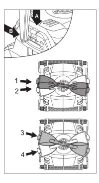
Cambiare la posizione diagonale della maniglia per il movimento di lato alla linea di galleggiamento. Per regolare l'angolo dell'impugnatura:
